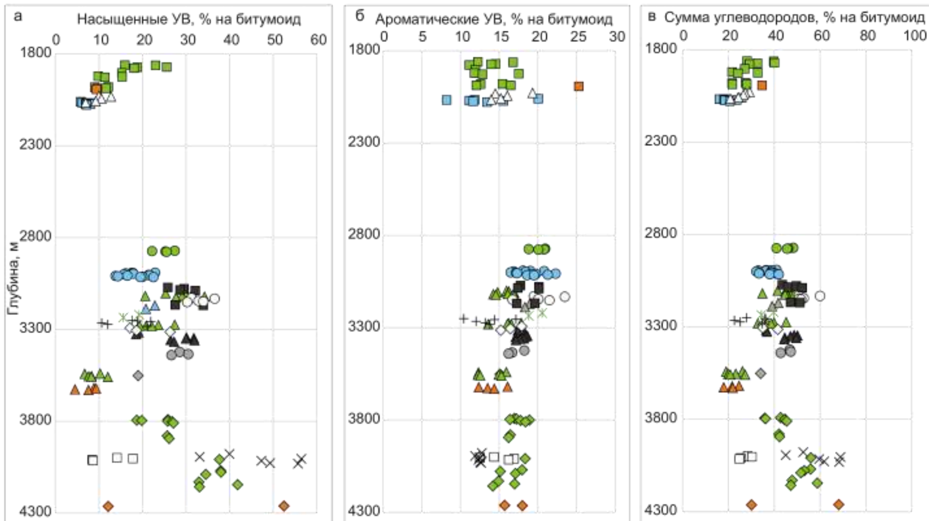
Рисунок 3.25 – Диаграммы зависимости от глубины отбора образцов содержания насыщенных углеводородов (а), ароматических углеводородов (б) и суммарного содержания углеводородов (в) в битумоидах
